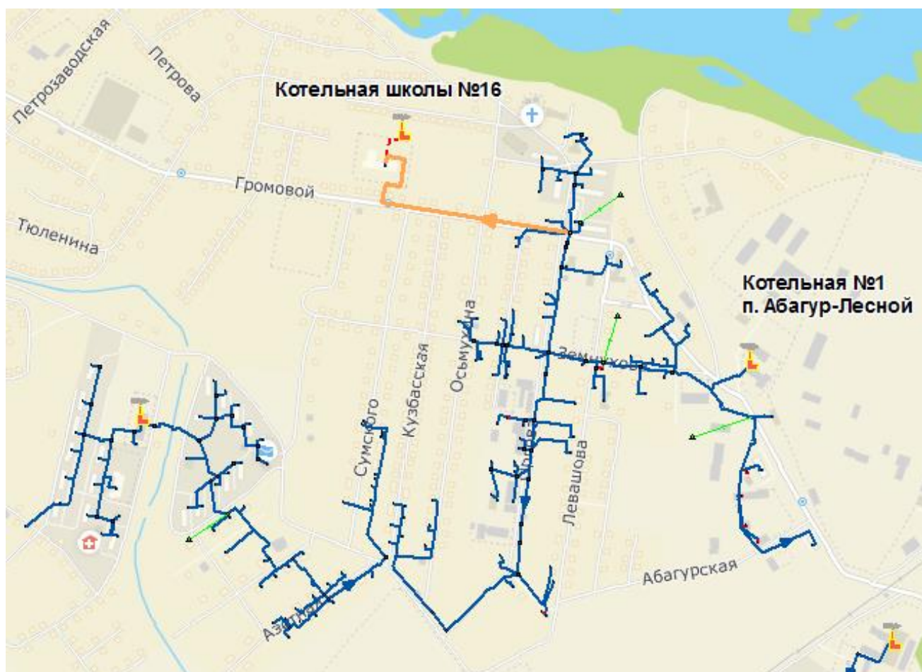
Рисунок 2 – Строительство тепловых сетей для переключения котельной школы №16 на котельную №1 п. Абагур-Лесной
